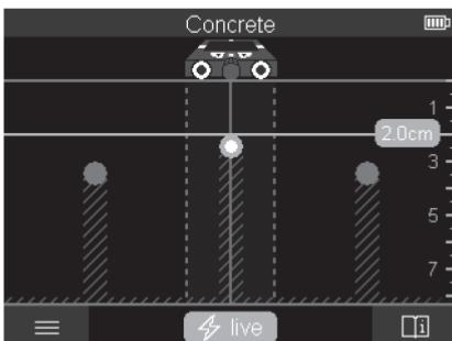
在 <物件畫面> 上可得到最佳測量結果及最大測量深度。在測量途徑中，將顯示所辨識的物體與深度資料，並視情況顯示材質屬性。
