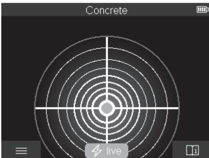
Hasil pengukuran pertama telah ditampilkan pada <Tampilan spot> tanpa menggerakkan alat pengukur di atas permukaan. Oleh karena itu tampilan ini sangat sesuai untuk pengukuran di area sudut atau ruang yang sempit. Kedalaman pengukuran maksimal sebesar 6 cm. Objek yang terdeteksi ditampilkan dengan karakteristik materialnya namun tanpa informasi kedalaman.
