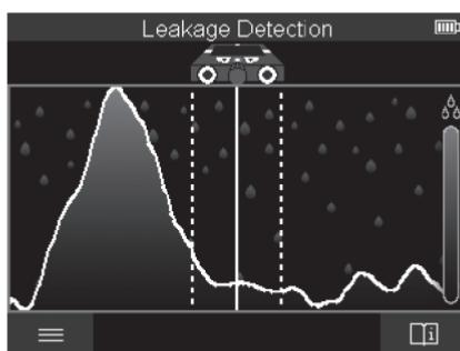
이 측정 모드에서는 표면 자재의 상대 습도가 표시됩니다. 따라서 습도가 가장 높은 자재 위치를 확인하고 이를 통해 누설이 발생할 수 있는 곳을 확인하기에 적합합니다.
