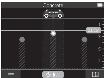
ใน <Object View> มีผลการวัดที่ดีที่สุดเท่าที่เป็นไปได้และความลึกในการวัดสูงสุดที่มีอยู่ วัสดุที่ตรวจพบจะแสดงอยู่เหนือส่วนการวัดพร้อมข้อมูลความลึกและอาจมีคุณสมบัติของวัสดุแสดงให้เห็น
