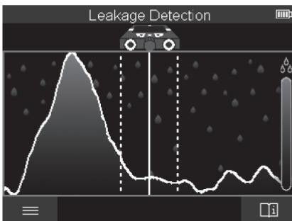
Pada mode pengukuran ini, kelembapan material relatif pada permukaan akan ditampilkan. Oleh karena itu, mode ini sesuai untuk mendeteksi kelembapan maksimal pada material dan kemungkinan kebocoran.
