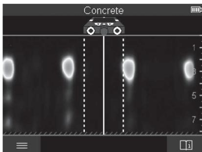
ใน <Signal View 2D> จะแสดงความแรงของสัญญาณที่ตำแหน่งวัดตามลำดับพร้อมกับความลึกของวัสดุ <Signal View 2D> เป็นอีกแบบหนึ่งของ <Object View> ซึ่งแสดงความแรงของสัญญาณแทนลักษณะวัสดุ ความแรงของสัญญาณสูงสุดแสดงถึงขอบด้านบนของวัสดุ
