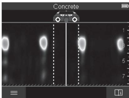
在**<二维信号视图>**中，将连同物体深度显示各个测量位置上的信号强度。**<二维信号视图>**是**<对象视图>**的一种类型。该视图显示信号强度而非物体图标。最大信号强度表示物体上沿。
