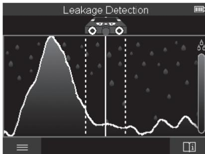
在這個測量模式中，顯示物體表面的相對材質濕度。因此它適用於定位最高材質濕度的位置，從而確定可能的洩漏點。
