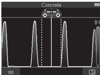
在**<信号视图>**中，将显示各个测量位置上的信号强度，不带物体深度信息。**<信号视图>**可用于定位紧靠在一起的物体以及根据信号走向更好地预估复杂的材料结构。
