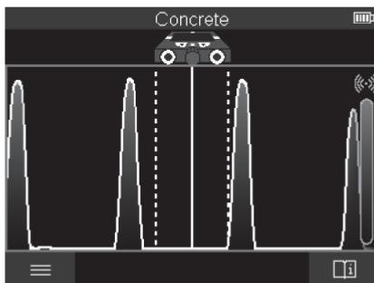
ใน <Signal View> จะแสดงความแรงของสัญญาณที่ติดแผ่นหินตามลำดับ โดยไม่แสดงความลึกของวัสดุ
