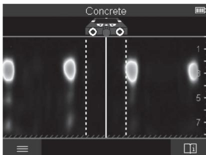
在 <2D 訊號畫面> 中，顯示各個測量位置與結合物體深度的訊號強度。此 <2D 訊號畫面> 是 <物件畫面> 的一種類型。它以顯示訊號強度取代物體符號。物體上緣呈現最大的訊號強度。
