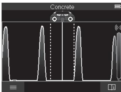
在 <訊號畫面> 中，顯示各個測量位置的訊號強度，不包含物體深度資訊。
