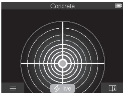
ใน <Spot View> ผลการวัดระยะประภัยขึ้นโดยไม่ต้องเคลื่อนเครื่องมือวัดไปที่พื้น ดังนั้น จึงเหมาะสมอย่างยิ่งสำหรับการวัดในมุมหรือในพื้นที่แคบ ความลึกสูงสุดในการวัดคือ 6 ซม. จะแสดงคุณสมบัติของวัสดุถูกที่ตรวจสอบ แต่ไม่มีข้อมูลเชิงลึก
