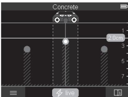
在<对象视图>中提供最佳测量结果以及最大测量深度。所识别的物体将沿着测量距离连同深度说明以及必要时连同材料属性一起显示。
