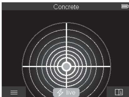
在<点视图>中，将显示第一个测量结果，无需将测量仪移动到基底上方。因此该视图特别适用于角落里或狭窄部位上的测量。最大探测深度为6厘米。获寻物可能一同显示材料属性，但不显示深度数据。
