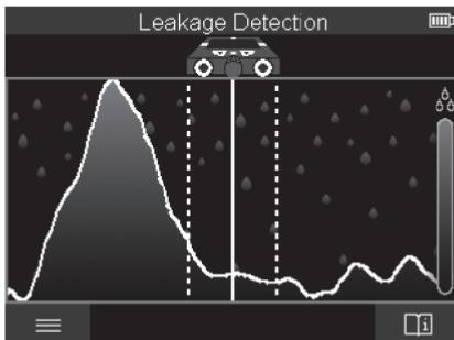
在该测量模式下，将显示表面的相对材料适度。因此该模式适用于确定材料湿度最大的位置，从而定位可能存在的泄露位置。
