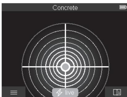
無須將測量工具在基材上移動，即已在 <定點畫面> 上顯示第一個測試結果。因此特別適用於邊角或狹窄處的測量。最大探測深度是 6 公分。找到的物體可能視情況顯示其材質屬性，但無深度資料。
