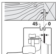
A marcação de corte 0° (10) indica a posição do disco de serra num corte em ângulo reto. A marcação de corte 45° (9) indica a posição do disco de serra num corte num ângulo de 45°.
