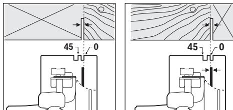
เครื่องหมายตัด  $0^\circ$  (10) และดึงตัวแทนงของใบเลื่อยสำหรับการตัดเป็นมุมฉาก เครื่องหมายตัด  $45^\circ$  (9) และดึงตัวแทนงของใบเลื่อยสำหรับการตัด  $45^\circ$  เพื่อให้ได้การตัดที่แม่นยำ ให้จับเลื่อยวงเดือนข้าหาชิ้นงานดังแสดงในภาพ ทางที่ต้องกับสีที่สุดควรฝึกซ้อมการตัดก่อน
