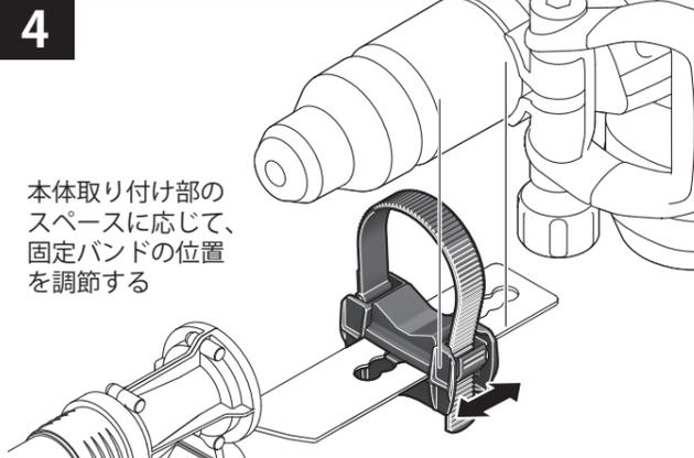
本体取り付け部のスペースに応じて、固定バンドの位置を調節する
