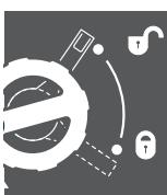
顯示鎖定桿在固定鋸片時的位置，和調整垂直方向的斜角鋸割角度（可以擺動鋸片）時的位置。
