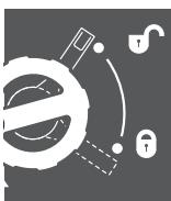
显示锁定杆在固定锯片时的位置，和调整垂直方向的斜角锯割角度（可以摆动锯片）时的位置。
