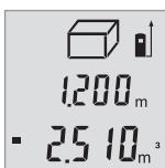
Setelah selesai pengukuran ketiga, volume secara otomatis dihitung dan ditampilkan. Hasil akhir pengukuran ada pada bagian bawah nilai yang diukur saat ini.
