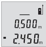
要将测量值相加，按压按键 6，要将测量值相减，按压按键 3。结果出现显示屏下部 "=" 的后面，上方是当前测量值。
