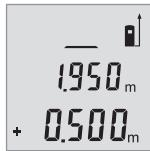
Tekan tombol **6** untuk penambahan pengukuran tombol atau untuk pengurangan nilai pengukuran tombol **3**. Tanda „+“ atau „-“ akan ditampilkan di layar bagian bawah. Lakukan pengukuran lain. Nilai pengukuran saat ini ditampilkan di layar bagian bawah nilai pengukuran sebelumnya.
