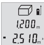
두 번째 측정이 끝난 후에 체적이 자동으로 계산되어 표시됩니다. 최종 결과가 디스플레이 하단에, 현재 측정값이 그 위에 표시됩니다.
