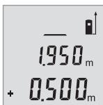
要将测量值相加，按压按键 6，要将测量值相减，按压按键 3。在显示屏下部出现 "+" 或 "-"。进行下一个测量。当前测量值显示在显示屏下部，上一行是上一次测量值。
