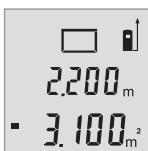
두 번째 측정이 끝난 후에 면적이 자동으로 계산되어 표시됩니다. 최종 결과가 디스플레이 하단에, 현재 측정값이 그 위에 표시됩니다.
