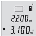
两次测量结束后会自动计算和显示面积。最终结果显示在显示屏下部，在当前测量值的上方。
