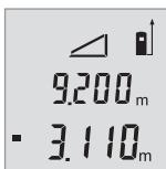
Setelah selesai pengukuran kedua, tinggi secara otomatis dihitung dan ditampilkan. Hasil akhir pengukuran ada pada bagian bawah nilai yang diukur saat ini.
