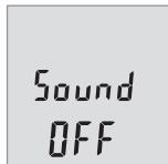
請長按測量按鈕 2，直到螢幕 1 出現 "Sound OFF" 即關閉響音信號。放開按鈕後，測量工具即以此新設定啟動。
