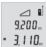
두 번째 측정이 끝난 후에 높이가 자동으로 계산되어 표시됩니다. 최종 결과가 디스플레이 하단에, 현재 측정값이 그 위에 표시됩니다.
