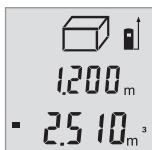
三次测量结束后会自动计算和显示体积。最终结果显示在显示屏下部，在当前测量值的上方。
