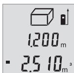
完成第三次測量後，測距儀將自動計算出體積並於畫面中顯示該值。最後的計算結果位於螢幕的下方區域，而該次的實際測量值則位於其上方。
