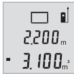
完成第二次測量後，測距儀將自動計算出面積並於畫面中顯示該值。最後的計算結果位於螢幕的下方區域，而該次的實際測量值則位於其上方。
