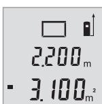
Setelah selesai pengukuran kedua, luas permukaan secara otomatis dihitung dan ditampilkan. Hasil akhir pengukuran ada pada bagian bawah nilai yang diukur saat ini.
