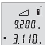
两次测量结束后会自动计算和显示高度。最终结果显示在显示屏下部，在当前测量值的上方。
