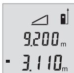
完成第二次測量後，測距儀將自動計算出高度並於畫面中顯示該值。最後的計算結果位於螢幕的下方區域，而該次的實際測量值則位於其上方。
