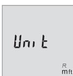
Tekan lama tombol on/off **5**. Saat nilai pengukuran yang diinginkan sudah ditampilkan, lepaskan tombol on/off **5**. Setelah melepaskan penekanan tombol, alat pengukur akan aktif dengan penyetelan yang dipilih.
