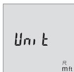
长按起停开关 5。一旦显示所需测量单位，就松开起停开关 5。松开后，测量仪以所选择的设置自动打开。
