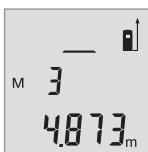
在 "M" 后面显示测量值编号，下方显示相应的测量值。
