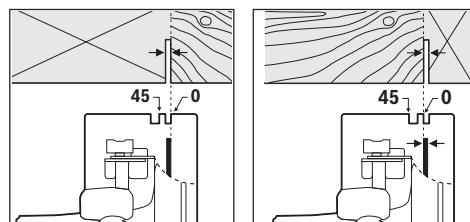
เครื่องหมายตัด 0° (10) และ 45° (9) แสดงตำแหน่งของใบเลื่อยสำหรับ การตัดเย็บมุมจาก เครื่องหมายตัด 45° (9) แสดงตำแหน่ง ของใบเลื่อยสำหรับการตัด 45°
