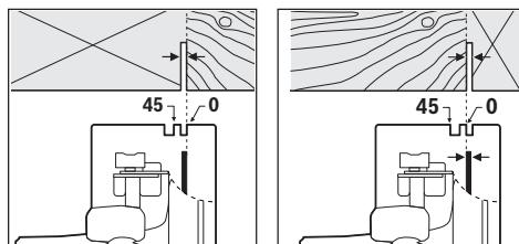
A marcação de corte 0° (10) indica a posição do disco de serra num corte em ângulo reto. A marcação de corte 45° (9) indica a posição do disco de serra num corte num ângulo de 45°.
