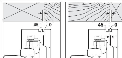
Dấu cắt  $0^{\circ}$  (10) hiển thị vị trí của lưỡi cưa ở vết cắt vuông góc. Dấu cắt  $45^{\circ}$  (9) hiển thị vị trí của lưỡi cưa ở vết cắt  $45^{\circ}$ .
