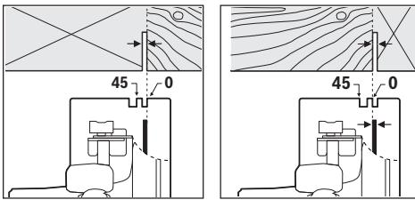
علامت برش  $0^{\circ}$  (10) وضعیت تیغه اره را در برش با زاویه  $0^{\circ}$  عمودی نشان می‌دهد. علامت برش  $45^{\circ}$  (9) وضعیت تیغه اره را در برش با زاویه  $45^{\circ}$  نشان می‌دهد.
