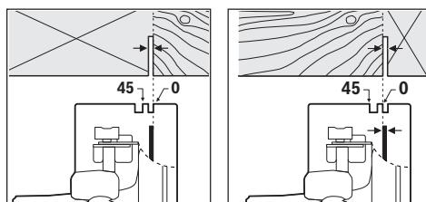
Tanda pemotongan 0° (10) menunjukkan posisi mata gergaji pada pemotongan persegi. Tanda pemotongan 45° (9) menunjukkan posisi pada mata gergaji pemotongan 45°.
